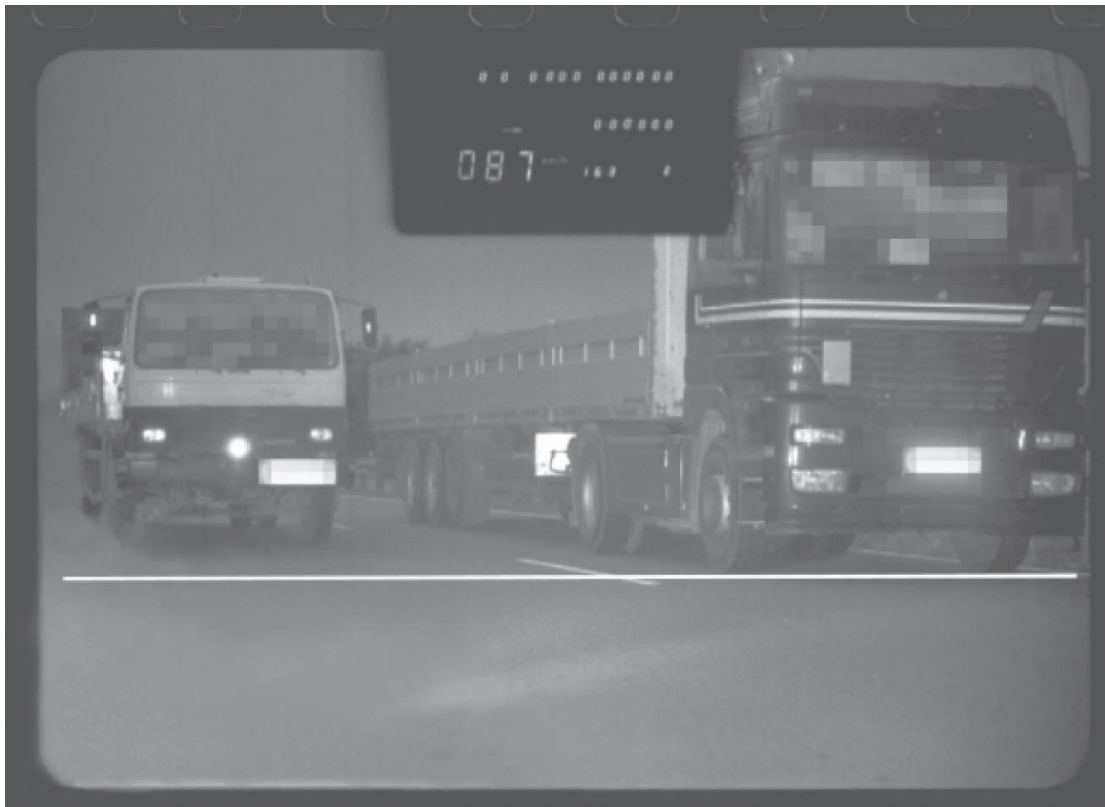
Abbildung 7 – Verkehr auf mehreren Fahrstreifen, Überholverkehr, mit Messlinie
