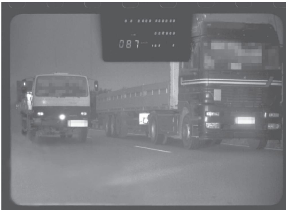
Abbildung 6 – Verkehr auf mehreren Fahrstreifen, Überholverkehr, Messwertzuordnung
